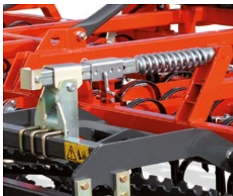
REGOLAZIONE DOPPIO RULLO POSTERIORE ADJUSTMENT OF DOUBLE REAR ROLLER DEPTH
