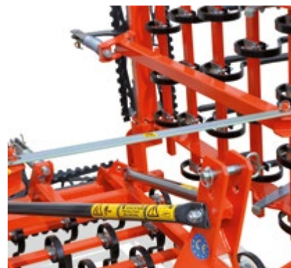
BARRA DI SICUREZZA PER IL TRASPORTO BARS FOR THE TRANSPORT SAFETY
